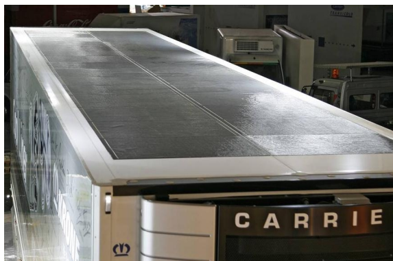
Холодильный прицеп, облицованный солнечными панелями (источник: Solarion AG)
